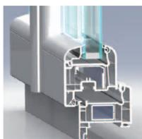
Dormant de 70 mm à 4 chambres aux parois de forte épaisseur offrant une résistance mécanique accrue. Vitrage 24 mm (4/16/4). Basse émissivité et gaz Argon de base.
